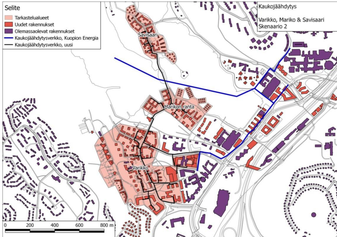
Kuva 14. Mallinnettu kaukojäähdytysverkon laajennus skenaariossa 2
